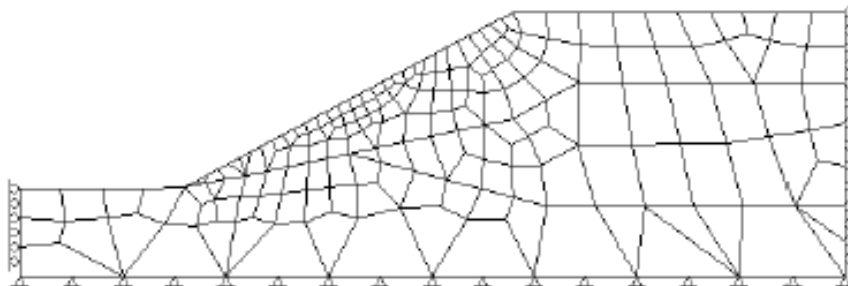
Figura 12.12. Malla de elementos finitos tipo Q8 para la resolución del problema propuesto. Cortesía de Rocscience.
