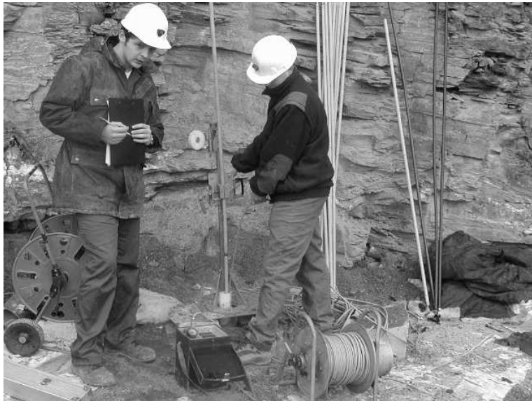
Figura 18. 24. Toma de datos en un sondeo mediante la sonda INCREX
