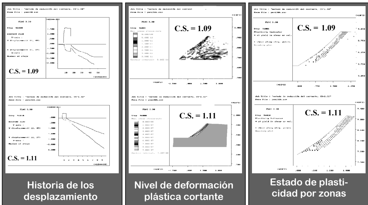
Figura 12.9: Resultados de FLAC, demostrativos del uso de la técnica de reducción de la resistencia.
