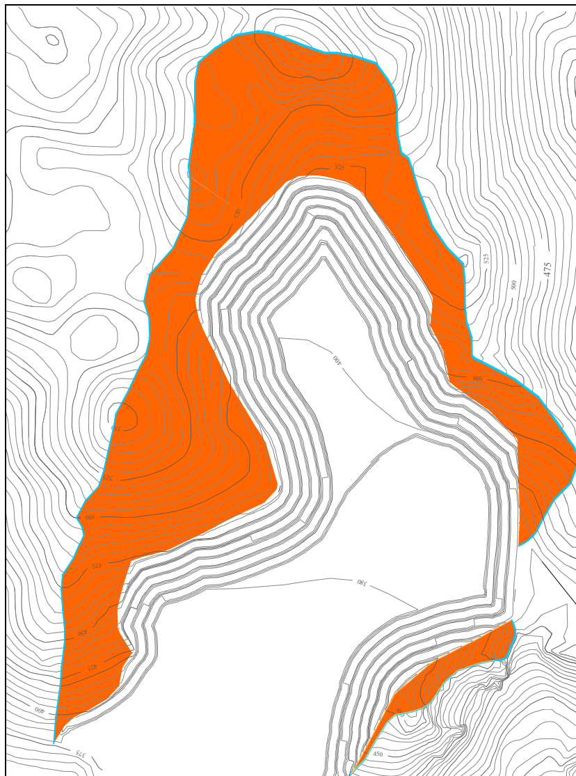
Figura 16.14. Cuencas de aporte a las cunetas perimetrales.
