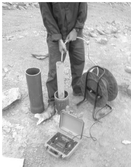
Figura 18. 17. Toma de datos en un sondeo mediante la sonda Inclinométrica
