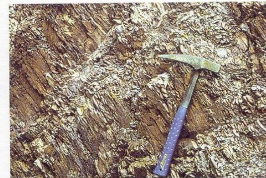
Pizarras paleozoicas. Calidad muy mala. Fracturación muy intensa. Grado de meteorización V.
